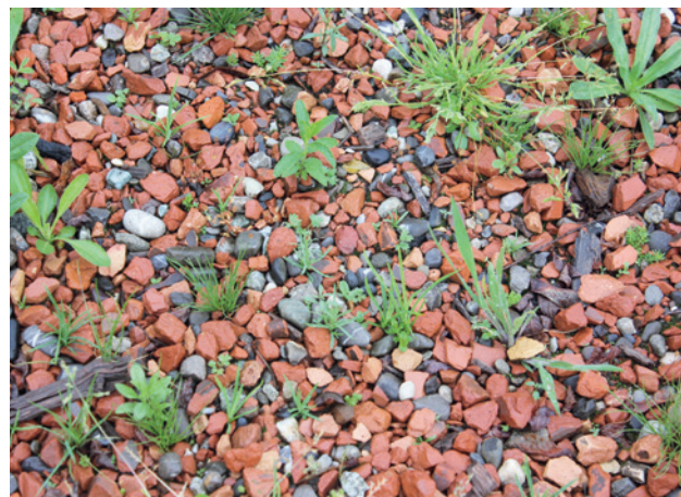
Figure 8 : Un substrat composé de 40% de gravier récupéré sur la toiture et recyclé, 50% de tuiles concassées et 10% de compost (©HEPIA/ E. Renaud)
